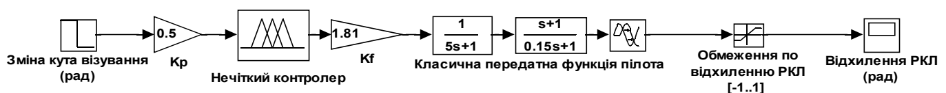
Рис. 4. Модель пілота із використанням нечіткого регулятора
